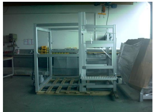
Bedienergestell mit Kabelkanälen für Extrusionsanlage
