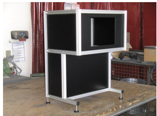
Gestell für Schwingungsprüfstand
